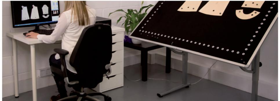
IsoDigit erkennt und digitalisiert interne Ausschnitte, Knipse, Bohrlöcher, interne Linien und Fadenläufe vollautomatisch. Die verwendeten Magnete für die Befestigung der Schablone werden dabei ignoriert.
